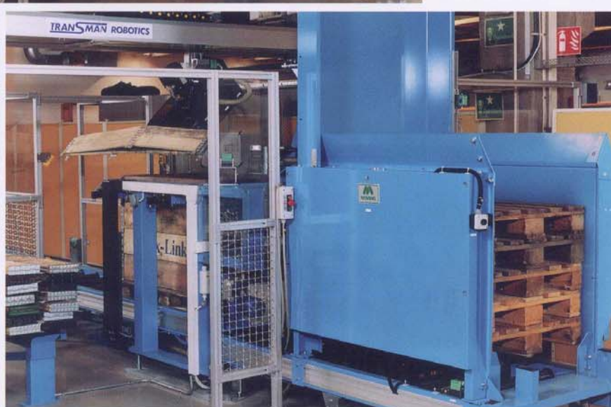
Pallmagasin för uppstapling av pall med plats för max 15 st. PALLE kan kompletteras med ett program kundanpassade tillval, såsom hantering av flera pallstorlekar, sortering av skadade och hela kragar mm.
