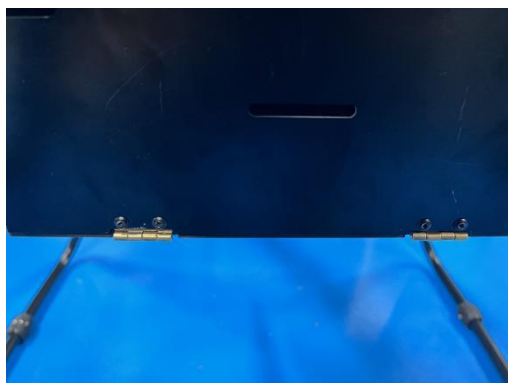
7、底板上两边的折叠叶片安装完成后，如图进行舱门的安装。（左图为舱门关闭，右图为舱门打开）
