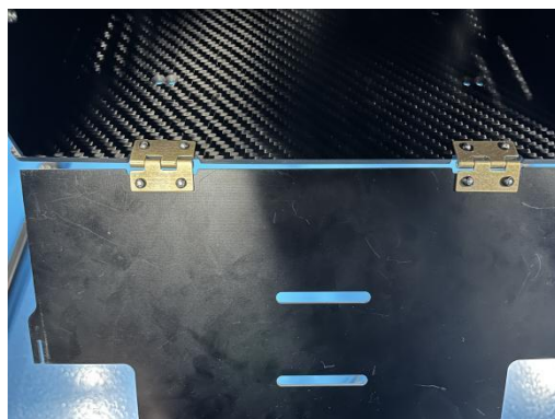
7、底板上两边的折叠叶片安装完成后，如图进行舱门的安装。（左图为舱门关闭，右图为舱门打开）
