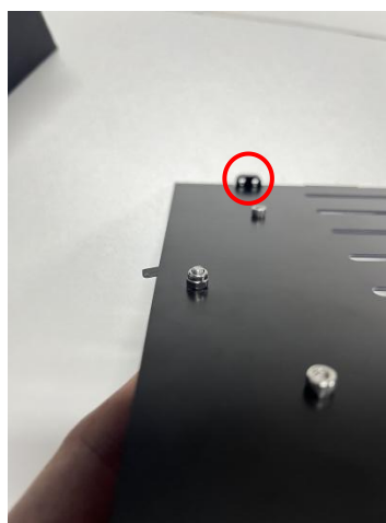
2、如图为电池箱内壁，舱门扣使用的螺丝为 M3*8 +螺母，固定条使用的螺丝为 M3*6 。
