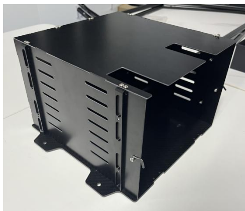
5、完成侧板安装后，如图使用 M3*6 的平头螺丝 安装上盖，上盖的缺口朝向舱门。
