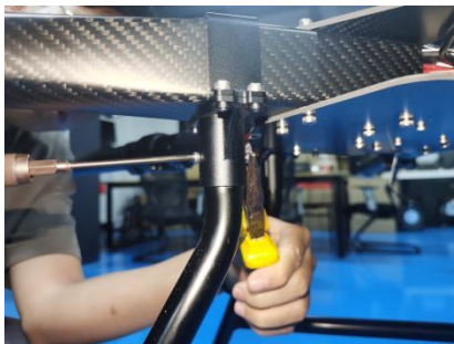
16、使用 M3*28 的螺丝与螺母，固定脚架。
