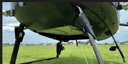
機体内部に荷物を格納、雨天時でも濡れることなく運搬可能
