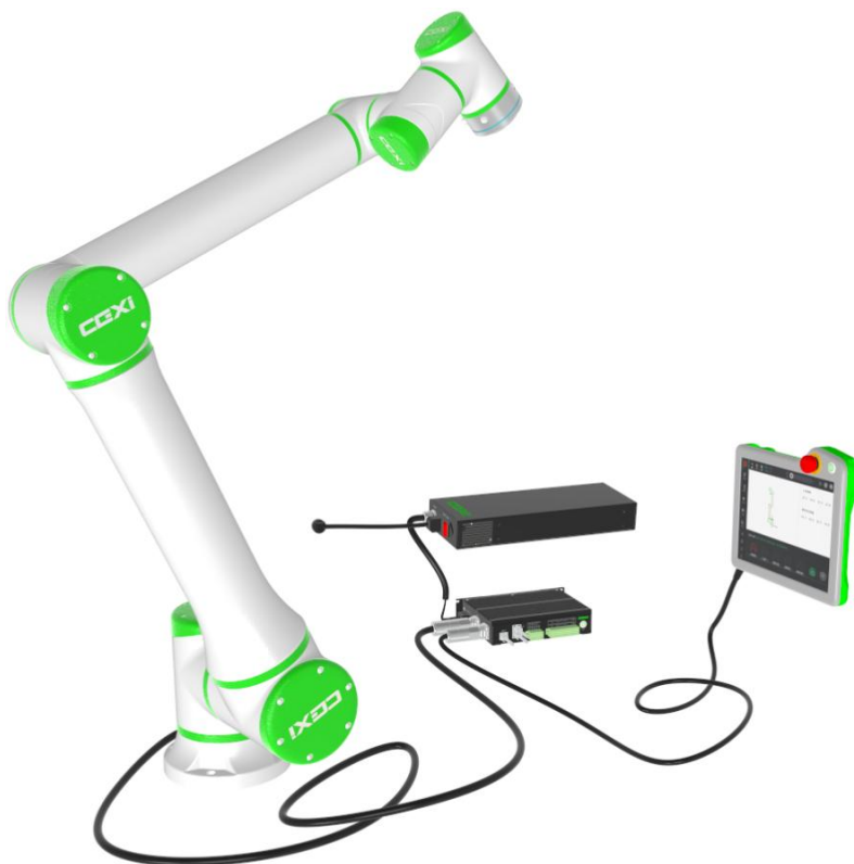
图 3 G 系列协作机器人+MK 控制器+电源盒的硬件连线图
