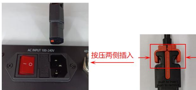
图 80 市井电源连接图
