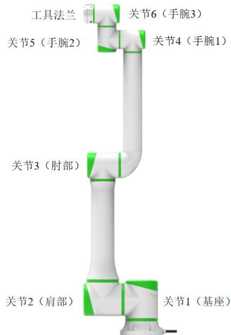
图 4 机械臂结构组成图
