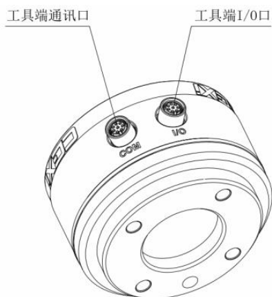
图 119 工具端电气通信接口示意图
