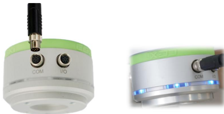
图 122 工具端 COM 口电气通信接口示意图
