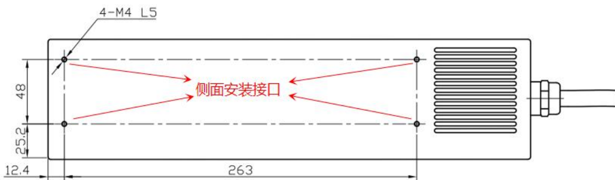
图 71 4000W 电源盒侧面安装尺寸图，单位 mm
