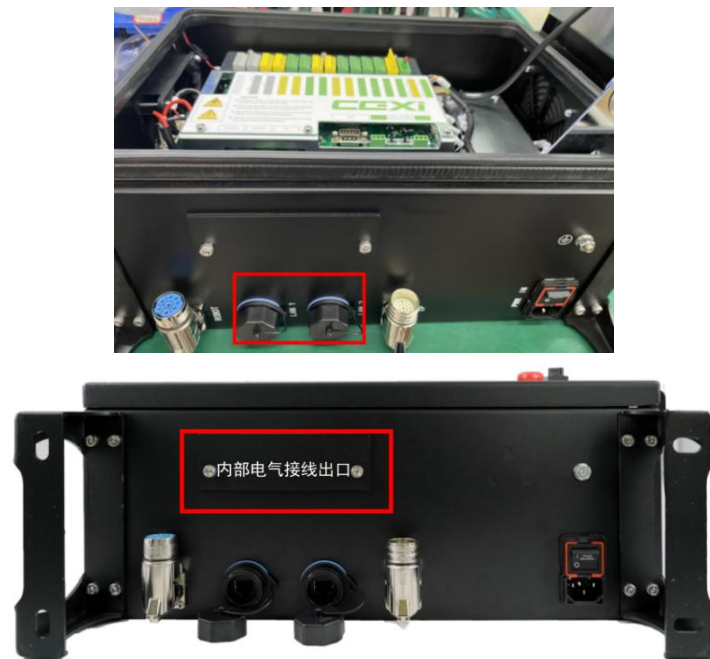
图 81 控制柜内部接口
