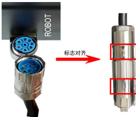
图 75 机械臂电缆连接图
