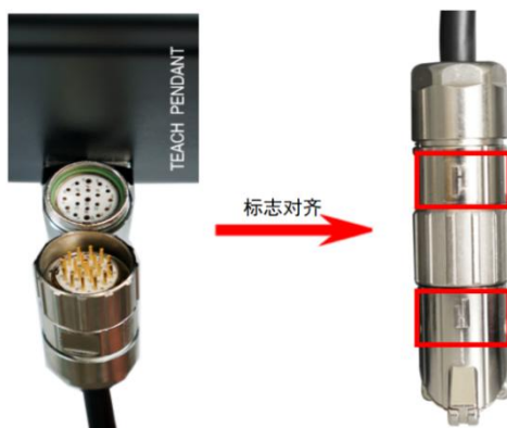
图 74 示教器电缆连接图
