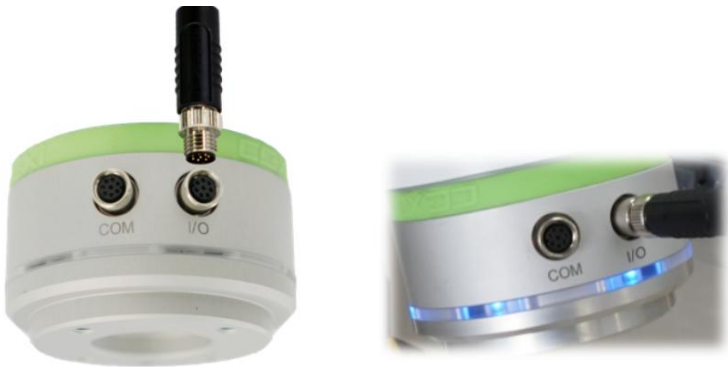
图 120 工具端 I/O 电气通信接口示意图
