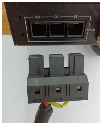
图 79 电源盒电缆连接图
