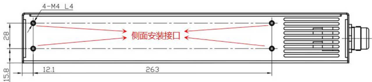
图 70 3000W 电源盒侧面安装尺寸图，单位 mm
