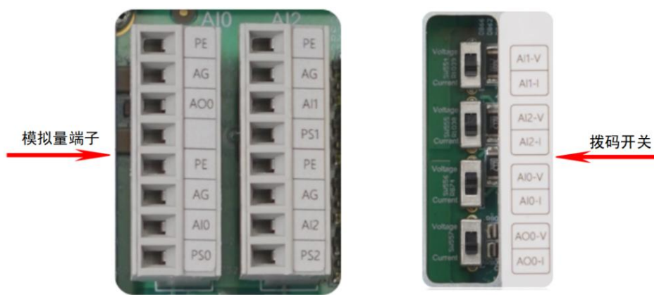
图 94 控制柜内部模拟量端子和拨码开关图
