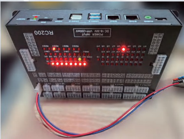
控制器 负责叉车运行控制 与调度系统通信
