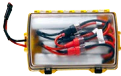
Battery Module HEPBATT1000
