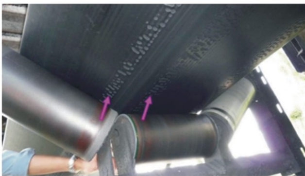
高接触压力区域的底面损坏
