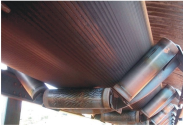
由于惰轮向前倾斜导致的皮带罩
